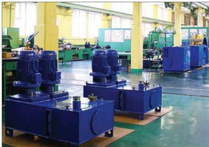
Комплектные гидроагрегаты для питания и управления работой различных гидравлических исполнительных устройств производятся серийно или могут быть спроектированы и изготовлены по техническому заданию заказчика на основе отечественных или импортных комплектующих.
